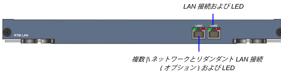
図 1-4 RMX 2000 の RTM LAN リアパネル配置
